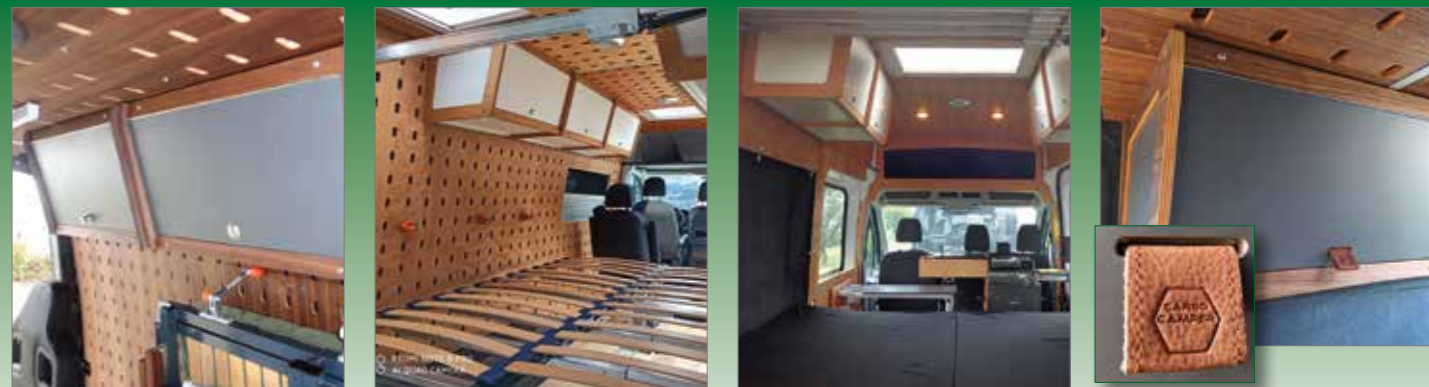
Der Hängeschrank wird an Wand und Decke befestigt
