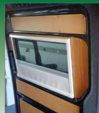
Nachträglich angebrachte Verdunkelung mit Mückenschutz an bereits vorhandenem Fenster
