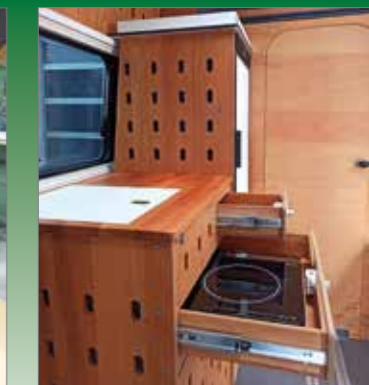
Das Küchenmodul eingebaut neben einem Kühlschrank-Modul
