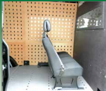
Lochreihen waagrecht auf Kundenwunsch in Boden mit zweiter Sitzbank integriert
