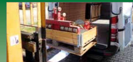
CargoPlate und Palette werden gemeinsam mit dem Stapler in den Transporter gehoben
