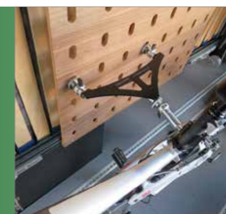
horizontale Befestigung eingebautes Vorderrad - 3-Punkt-Sicherung – extrem stabil - ohne Anschlag in Fahrtrichtung - parallel zur Seitewand
