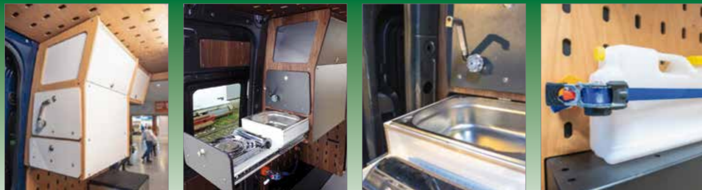
Das Küchen-Modul wird idealerweise neben der Schiebetürseite platzsparend angebracht, so dass sich der Auszug für die Kochstelle im Türbereich befindet
