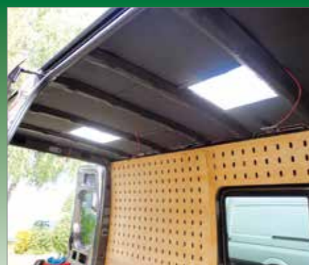
Deckenisolierung mit 2 Dachfenstern
