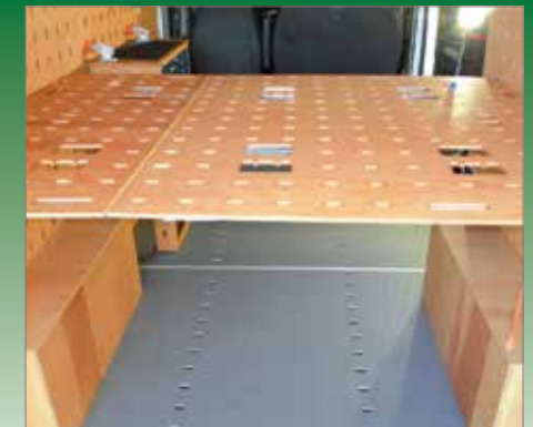
Die Trennwand als Zwischenboden und Bett
