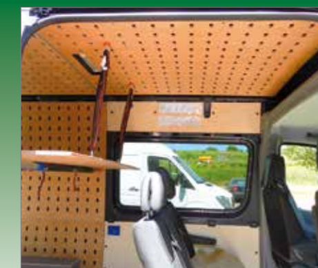
Es können auch nur Teilbereiche im Laderaum verkleidet werden
