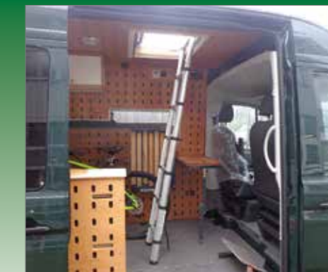
Durchstieg nach oben, auf das Dach, mit Leiter möglich
