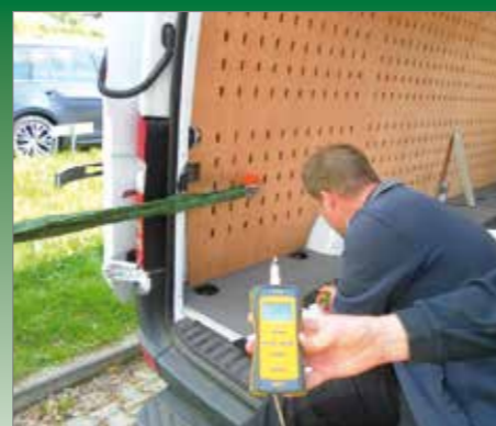
Sperrbolzen Zugversuch TÜV Zertifizierung
